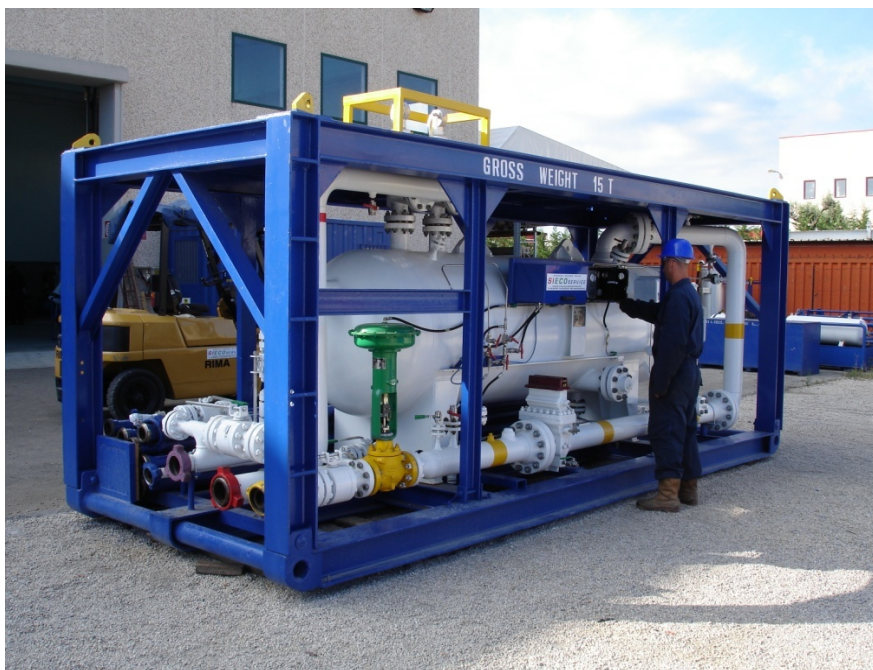
(SEPARATORE ORIZZONTALE TRIFASICO)
